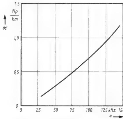
Bild 6. Die frequenzabhängige Dämpfung der Schleife bei Berkhof
