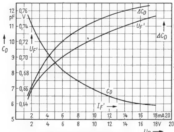
Bild 5. Vergleich des Funktionsverlaufes bei einer Diode OA 127 bzw. BA 121
