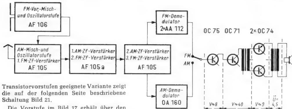
Bild 16. Prinzipschaltbild eines transistorbestückten AM/FM-Empfängers mit dem beschriebenen Nf-Verstärker in Gegentakt-B-Schaltung
