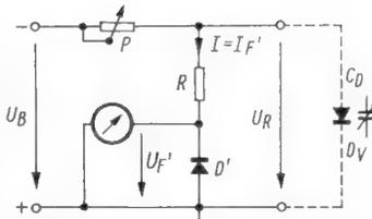
Bild 6. Prinzipschaltung zum Erzeugen der Steuerspannung  $U_R$  und der annähernd  $\propto C_D$  proportionalen Spannung  $U_F'$
