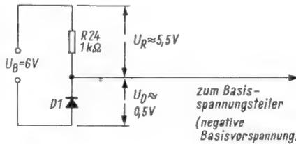
Bild 19. Ersatzschaltbild zum Darstellen der Wirkungsweise der Stabilisation mit Dioden
