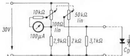
Bild 4a. Schaltungsbeispiel nach Bild 3 mit der Diode BA 124
