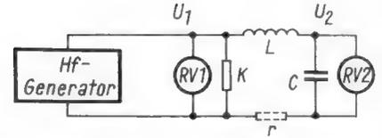
Daraus leitet sich das folgende Meßverfahren (Bild 5) her: Der zu messende Kreis LC ist mit einem Kopplungsglied K, dessen Wirk- oder Blindwiderstand sehr klein im Vergleich zum Wirk- oder Blindwiderstand des Kreises sein muß, an den Hf-Generator angekoppelt.  $U_1$  wird am Röhrenvoltmeter RV 1 abgelesen und die Spannung  $U_2$  am Röhrenvoltmeter RV 2. Das Verhältnis  $\frac{U_2}{U_1}$  gibt die Güte Q (Resonanzschärfe  $q$ )
