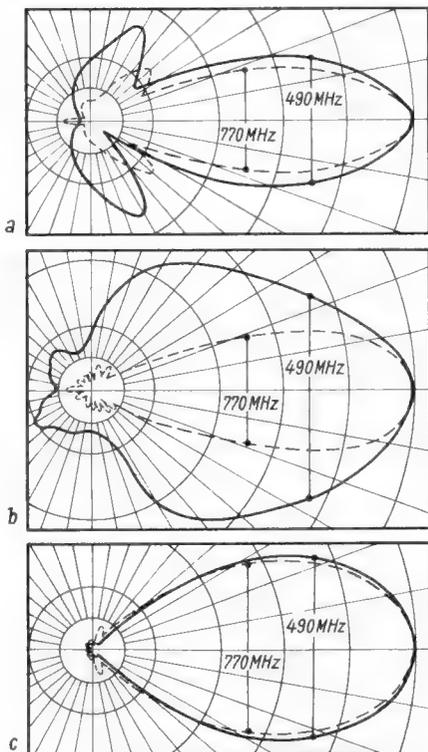
Bild 2. Vertikale Strahlungsdiagramme verschiedener Antennenarten, jeweils bei 480 MHz und 770 MHz; a = Flächenantenne, b = Breitband-Yagi-Antenne, c = logarithmisch-periodische Antenne
