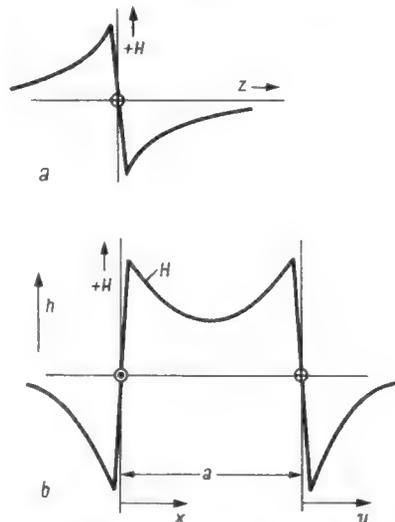
Bild 2. Die Berechnung der Feldstärke; a = Einzelleitung, b = Doppelleitung
