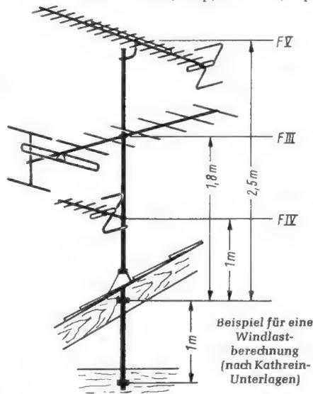
und  $F IV = 0,8 \text{ kp}$ . Die Antennen befinden sich in Höhen von 2,5 m, 1,8 m und 1 m. Dann erhält man
