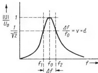
Bild 3. Bandbreite in einer Resonanzkurve
