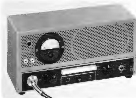
Bild 1. Das kombinierte Prüfgerät *Universer* enthält sechs Festfrequenz-Hf-Oszillatoren, einen 400-Hz-Tongenerator, einen Prüflautsprecher und einen Ausgangsspannungsindikator
