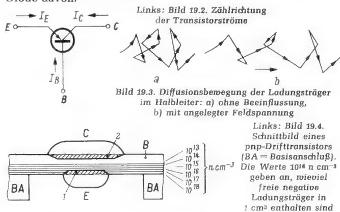
Die Art der Diffusionsbewegung von Ladungsträgern in Festkörpern zeigt schematisch **Bild 19.3a**. Wird ein elektrisches Feld angelegt, so überlagert sich dem Durcheinanderschwingen eine Gesamtbewegung in Richtung der elektrischen Kraftlinien, die größtmäßig von der Feldstärke bestimmt wird (**Bild 19.3b**). Diese sogenannte *Drift* ( $\approx$  Abtrieb) bleibt jedoch infolge der bei Transistoren üblichen geringen Span-
