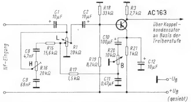
Bild 21. Variante der Schaltungen nach Bild 17 und 18 mit getrennten Potentiometern für die Bässe und die Höhen sowie mit lautstärkeabhängiger Klangentzerrung
