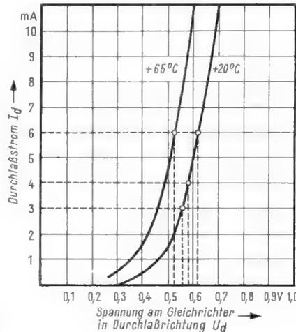
Bild 20. Das Durchlaßspannungs-/Durchlaßstrom-Diagramm einer Stabilisationsdiode
