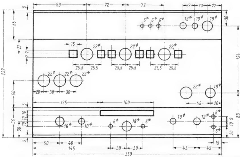
Bild 3. Zuschnitt und Bohrplan für das Chassis
