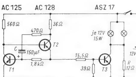
Links: Bild 4. Blinkschaltung für eine Batteriespannung von 12 V
