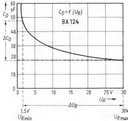
Bild 1. Sperrschichtkapazität als Funktion der Sperrspannung
