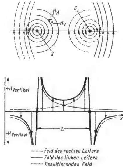
Bild 1. Feldausbreitung in einer Induktionsschleife; unten: die vertikal gerichteten Feldanteile des resultierenden Feldes über der Schleifenebene
