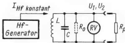
Bild 4. Bestimmung der Dämpfung aus dem Resonanzwiderstand
