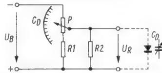
Bild 2. Schaltung zur Erzeugung der Diodensperresspannung; das Potentiometer P kann in Kapazitätswerten geeicht werden
