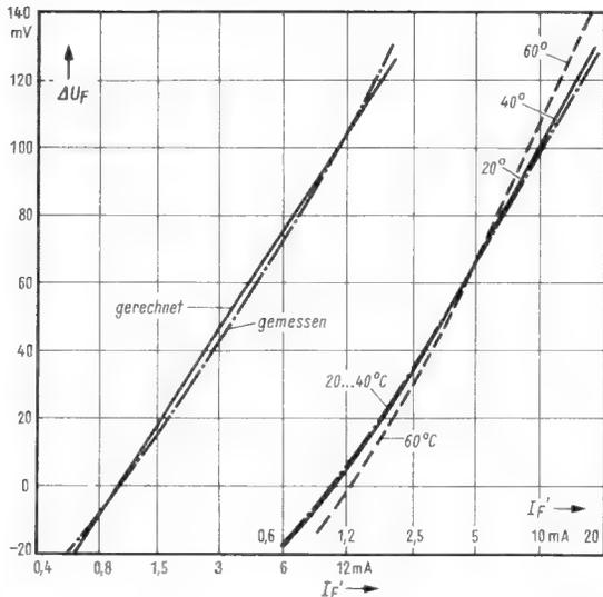
Bild 9. Links: Berechneter und gemessener Funktionsverlauf der Anzeigespannung. Rechts: Temperatureinfluss auf die Meßspannung
