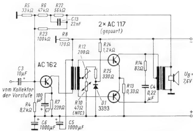
Bild 18. Schaltung eines Nf-Verstärkers ähnlich dem in Bild 17, jedoch mit Diodenstabilisation der Endstufen-Basisvorspannung und mit anderen Transistortypen
