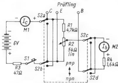
Bild 1. Die Schaltung des Transistor-Testers; M 1 = Drehspulinstrument 10 mA, M 2 = Drehspulinstrument 200  $\mu$ A, S 1 = einpoliger Druckknopftaster, S 2 = Zwergstufenschalter (zwei Stufen, vier Schaltarme), Gehäuse: Leistner Nr. 12
