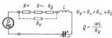
Bild 3. Ersatzschaltbild einer abgestimmten Induktionsschleife
