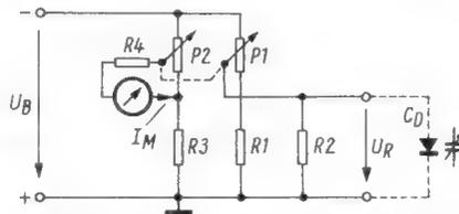
Bild 3. Schaltung zum Erzeugen der Steuerspannung und Anzeige der Diodenkapazität durch ein Zeigerinstrument
