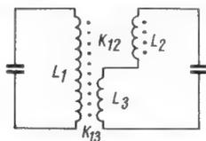
Bild 3. Magnetische Kopplung über einen Teil der Sekundärwicklung
