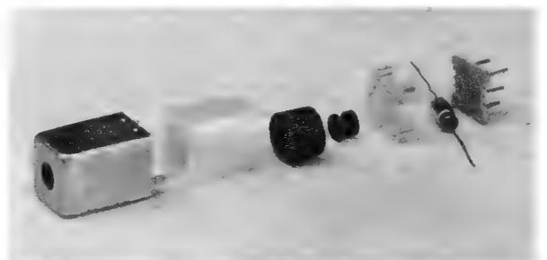
Rechts: Bild 2. Bestandteile der kompletten AM-Zf-Spule. Von links nach rechts: Abschirmhaube, Fassung für den Abgleichkern, Abgleichkern, Garnrolle, Sockel, Kreiskondensator, Hartpapierplatte
