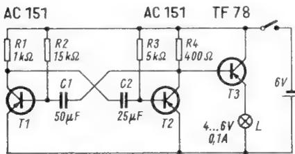
Bild 1. Elektronische Blinkschaltung mit einem astabilen Multivibrator als Taktgeber
