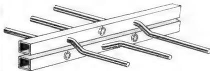
Bild 5. Prinzip der beiden Trägerrohre und der jeweils nur einseitig herausragenden Antennenelemente
