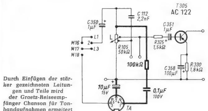
Durch Einfügen der stärker gezeichneten Leitungen und Teile wird der Graetz-Reiseempfänger Chanson für Tonbandaufnahmen erweitert
