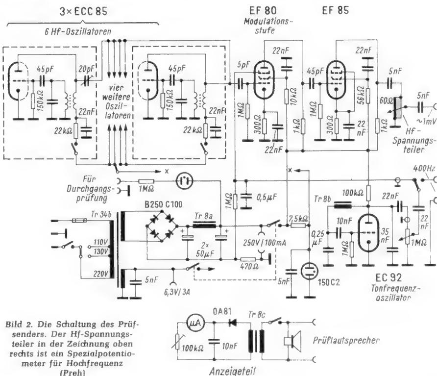
Bild 2. Die Schaltung des Prüfsenders. Der Hf-Spannungsteiler in der Zeichnung oben rechts ist ein Spezialpotentiometer für Hochfrequenz (Preh)
