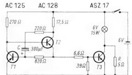
Bild 3. Blinkschaltung mit einem unsymmetrisch aufgebauten Multivibrator
