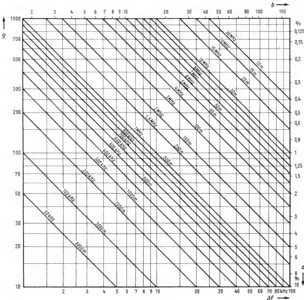
Bild 6. Zusammenhang zwischen Bandbreite  $\Delta f$ , Halbwertsbreite  $b$ , Resonanzschärfe  $q$  und Dämpfung  $d$
