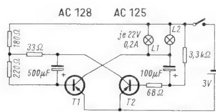
Bild 2. Blinkschaltung, bei der zwei parallelgeschaltete Lampen unmittelbar im Wirkungskreis des RC-gekoppelten Multivibrators enthalten sind
