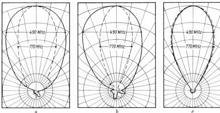
Bild 1. Horizontale Strahlungsdiagramme verschiedener Antennenarten, jeweils bei 480 MHz und 770 MHz; a = Flächenantenne, b = Breitband-Yagi-Antenne, c = logarithmisch-periodische Antenne
