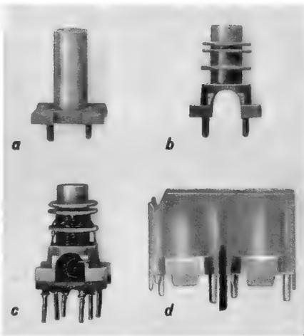
Bild 4. Bestandteile und Aufbau der FM-Zf-Spulen; a = Wickelkörper für Radiodetektorspule, b = Wickelkörper für die normale Kreisspule, die Spulenkörper sind nur rund 12 mm hoch, c = gewickelte FM-Spule mit eingelegtem Kondensator, d = Kunststoffkappe für FM-Filter mit halb eingeschobener Entkoppelscheibe
