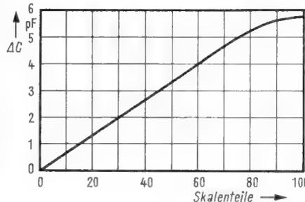
Bild 10. Verlauf der Kapazitätsänderung in Abhängigkeit von der Instrumentenanzeige bei einer Diode BA 121
